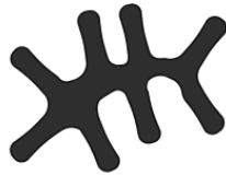
Figura 3 - Geometria da secção transversal de uma fibra 4DG TM . [16, 17]
